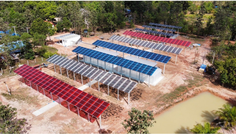
รูปที่ 2.11 แผงโซลาร์เซลล์แบบสี (Colored PV) จ. อุบลราชธานี
